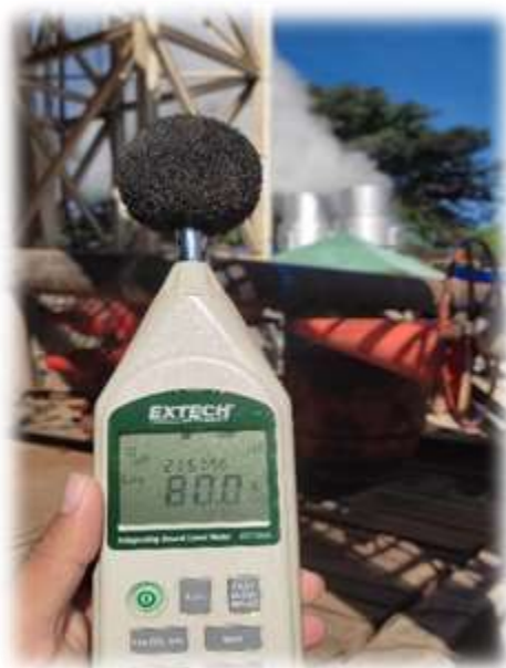
Figura 4: Monitoreo de Ruido durante descarga controlada de pozos.
