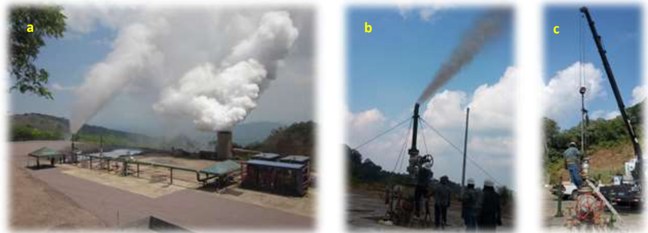
Ilustración 2 a) Descarga de pozo CHI-3B b) Intento de descarga CHI-5 c) Registro de Presión y Temperatura CHI-3B
