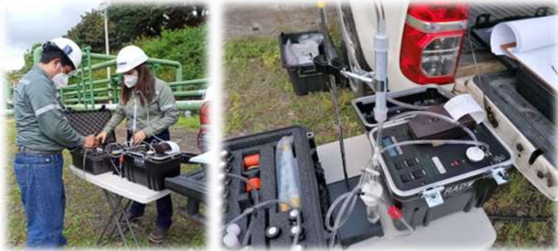
Figura 27: Pruebas preliminares del equipo RAD7 en fluido de pozo TR-18.
