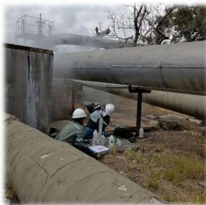
Figura 12: Pruebas de Inhibidores de Sílice en la CGA
