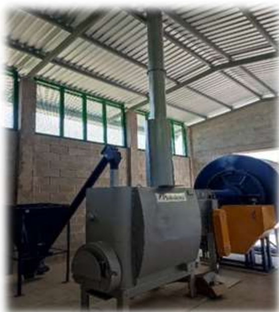
Figura 2. Máquina secadora de café instalada en el proyecto SECABE ubicado en la finca San Ramón, Berlín, Usulután.
