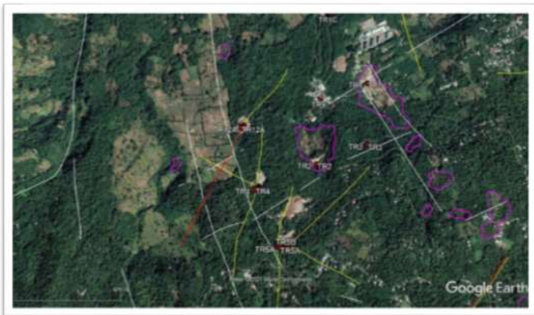
Figura 6: Proyección en superficie del pozo TR-12B (línea roja)
