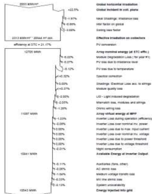
Figura 9. Diagrama de pérdidas y estimación de la energía eléctrica neta a producir durante un año típico del proyecto solar Zacatecoluca de 5.4 MWp.
