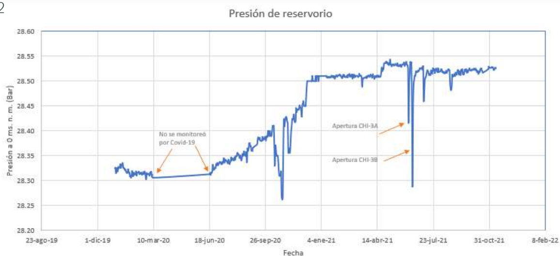
Gráfico 2 Comportamiento de la presión de reservorio medida en el pozo CHI-3 (Periodo 2020-2021)
